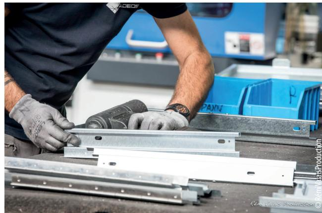
Assemblage d'une trappe de réalimentation
